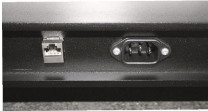
Sockel hinten: integrierte Anschlüsse für Strom und LAN
