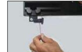
Durch ziehen an der Schnur wird das Display ge- und entsichert.
